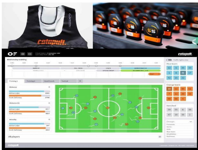
Рисунок 1 – Передвижной кейс с GPS-устройствами, эластичный топ-жилет, облачно-аналитическая платформа OpenField (Optimeye S5; Catapult Innovations of Australia, Melbourne)
